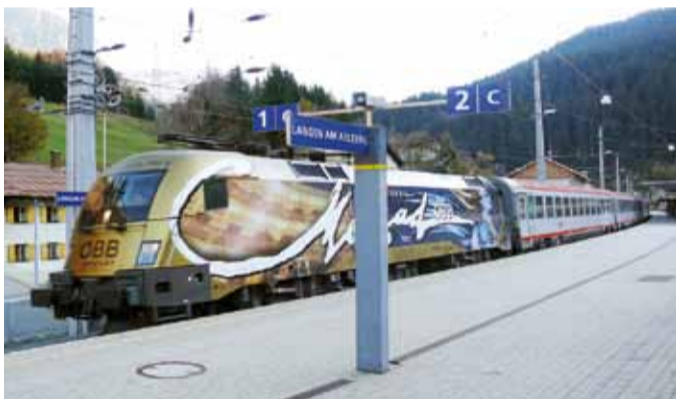
BEZ PŘEPŘAHU. Vícesystémové lokomotivy, mezi něž patří i řada 1216 Taurus, umožňují plynulý přechod napájecích soustav.
