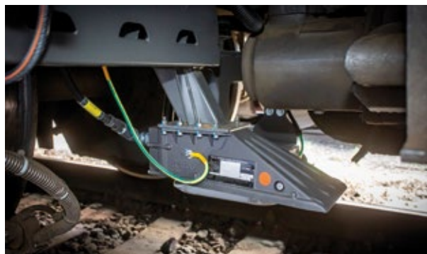
Senzor ETCS DRS05S1 na lokomotivě řady 362
