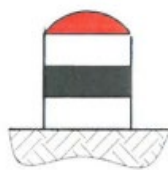
Obr. 1 návěstidlo k upozornění na hranici izolovaného úseku
