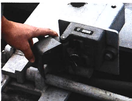
Obr. 2 – Spojovací zámek kontrolní uzamykacího ústrojí
